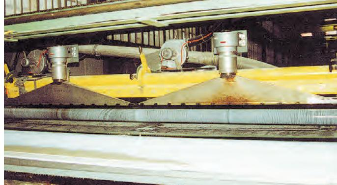
Два воздухонагревателя и два вентилятора при сушке пропитанных асбестовых труб.
